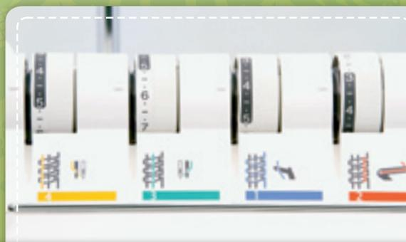
*Schnittbreitenverstellung: Breitere oder schmalere Nähte? Hierzu einfach die Schnittbreitenverstellung verwenden, eine Skala hilft die richtige Schnittbreite zu finden.*
