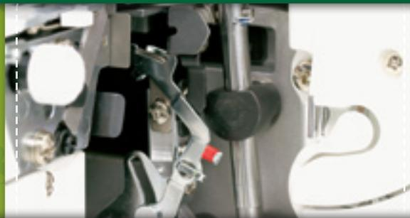
*Einfädelhilfe für Ober- und Untergreifer: leicht und schnell einzufädeln, folgen Sie einfach den Fadenkanälen und Einfädelpunkten.*
